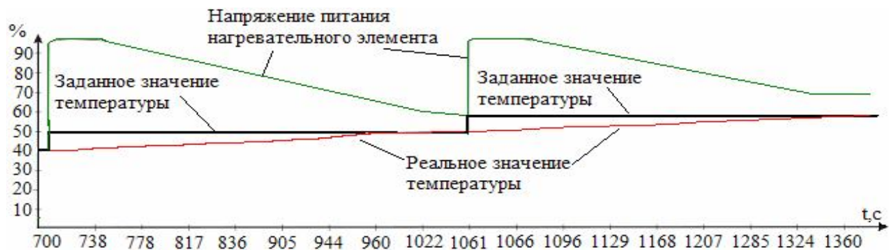
Рисунок 7 – Серия из двух экспериментов для системы регулирования температуры жидкости
