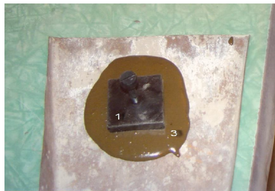
Рисунок 5 – Определение липкости химического состава ампул адгезиометром к материалу породы: а – общий вид; б – схема эксперимента
