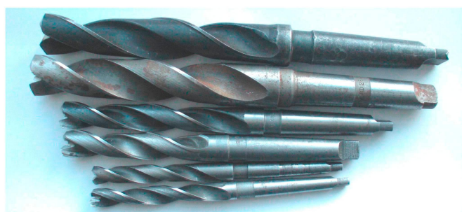
Рисунок 2 – Опытные образцы двухвершинных спиральных свёрл без поперечной кромки
