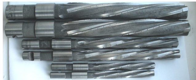
Рисунок 3 – Опытные образцы зенкера-протяжки
