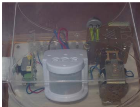
Рисунок 6 - Многофункциональная система освещения с детектором движения
