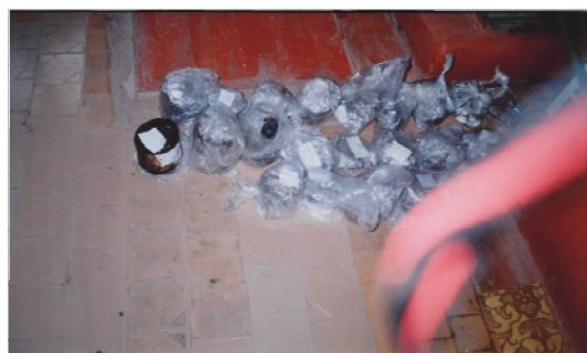
Рисунок 12 - Пробы грунтов для определения влажности завернуты в марлю и залиты парафином
