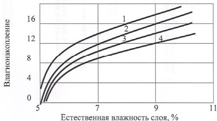
Рисунок 1 – Зависимость влагонакопления от естественной влажности грунта: 1 – супесь пылеватая; 2 – суглинок легкий; 3 – суглинок тяжелый; 4 – глина
