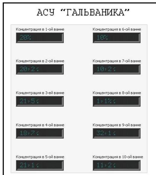
Рисунок 4 - Внешняя панель виртуального прибора для измерения концентрации веществ
