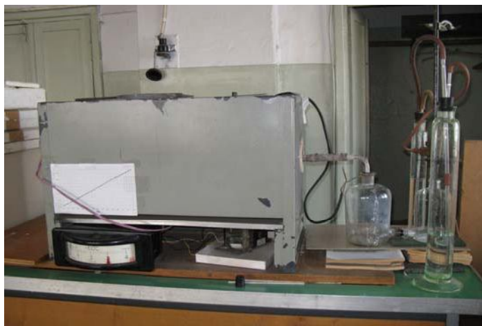
Рисунок 2 – Лабораторная установка для спекания шлака с фторидом аммония
