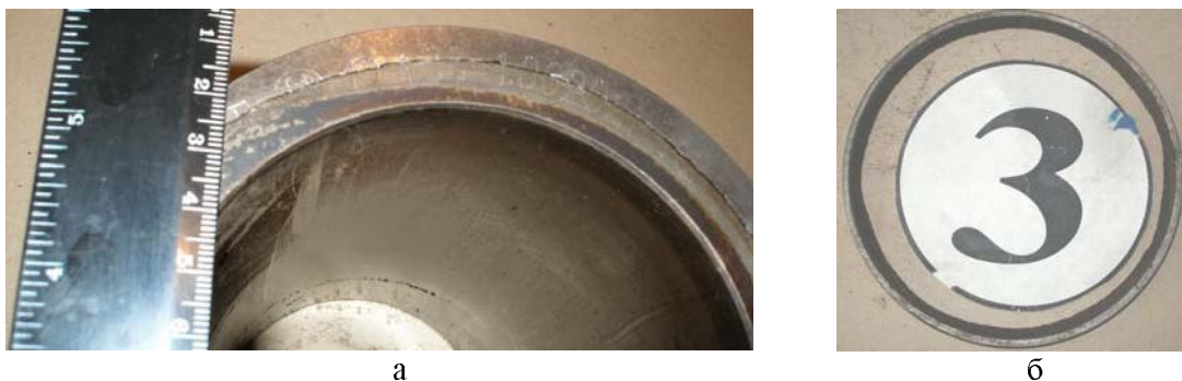
Рисунок 1 - Разрушение буртика исследуемой гильзы: а – совмещение разрушенных фрагментов по месту излома, б – кольцевой фрагмент буртика гильзы
