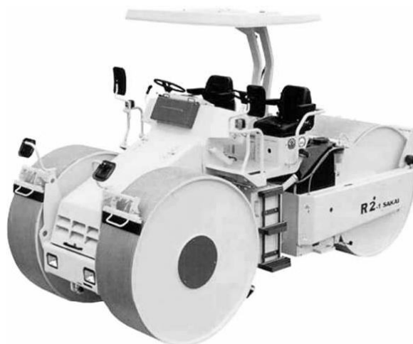
Рисунок 2 – Трехвальцовый 2-осный каток R-2 фирмы «Sakai» с одинаковым диаметром и распределенной массой всех валцов
