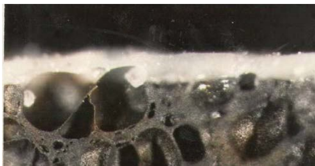
Рис. 3. Микроструктура среза субстрата с нанесенным адгезивом НТ- 35%, 75-кратное увеличение.
