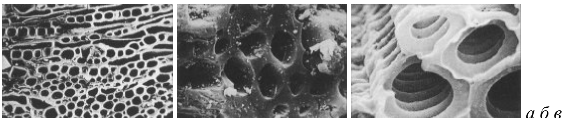
Рис. 1. Структура пор активированного угля: а – карбонизированная древесина; б – активированный каменный уголь; в – активированный уголь из скорлупы кокосов
