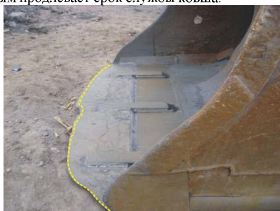
Рис. 5. Скол на режущей кромки ковша TORO-009
