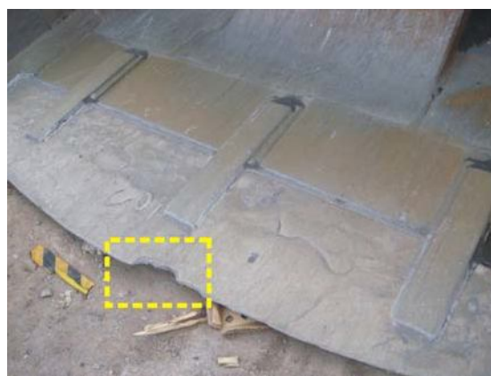
Рис. 6. Линия неравномерного износа режущей кромки TORO-009
