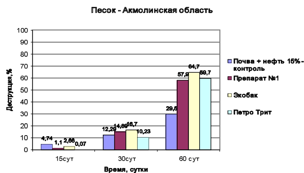
Рис. 8. Эффективность процесса деградации нефти биопрепаратами в песчаной почве Акмолинской области при 15%-ном уровне загрязнения
