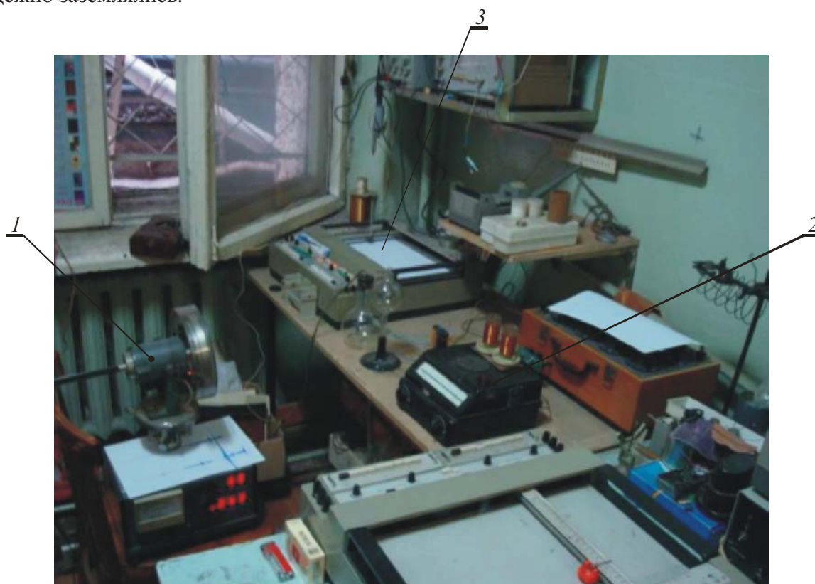
1 – гироскоп; 2– микроамперметр М95; 3– самописец Н306
