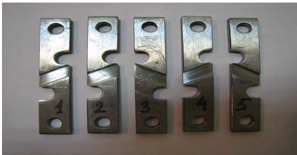
Рисунок 2. Специальные образцы для испытания на простой сдвиг
