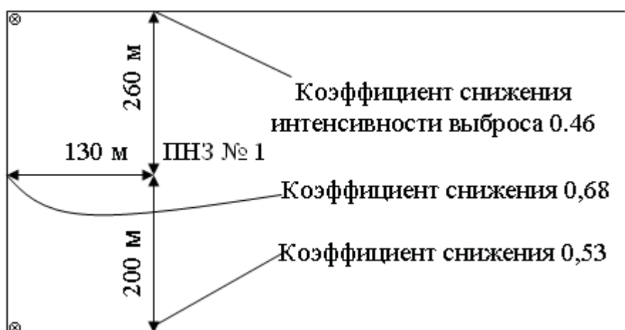
Рисунок 7. Результаты расчета концентрации автомобильных выбросов в атмосфере на перекрестке улицы Сатпаева, проспектов Сейфуллина и Абая
