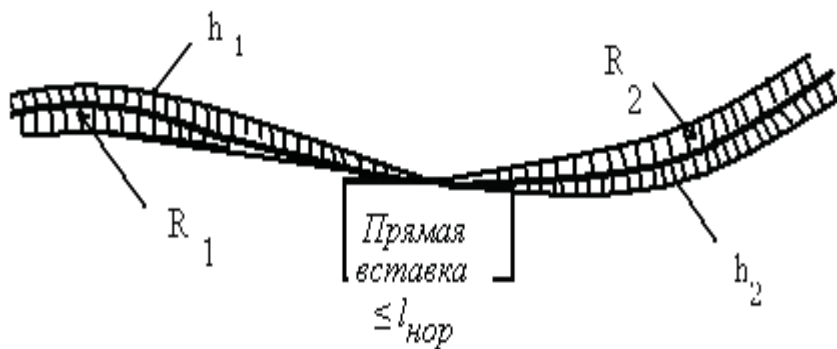
Рисунок 3 – Схема отводов возвышения наружной рельсовой нити при сопряжении смежных кривых одного направления при недостаточной длине прямой вставки между ними и соединении их встык
