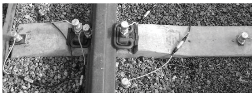
Рисунок 1. Схема расположения датчиков вибрации на элементах верхнего строения пути со скреплением типа ЖБР с полимерным боковым упором
