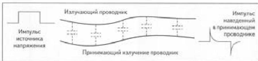
Рисунок 2 - Импульсная наводка через емкостную связь между проводниками
