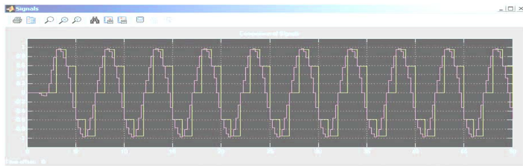
Рис. 3. Результат моделирования работы сплайн интерполятора с демонстрационной программы моделирования в Simulink
